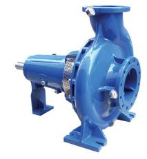
Одноступенчатые насосы консольного типа на раме с закрытым рабочим колесом предназначены для перекачки чистых жидкостей с содержанием абразивных частиц размером до 0,1 мм., концентрацией до 0,2%. и температурой до 140 °C.
