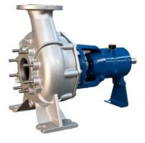
Горизонтальные центробежный насосы с вихревым рабочим колесом предназначены для перекачки жидкостей с содержанием взвешенных и волокнистых частиц соответствующих 90% от диаметра свободного прохода, концентрацией до 10%, температурой до 110 °C.
