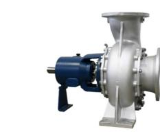
Горизонтальные центробежный насосы с многоканальным рабочим колесом предназначены для перекачки жидкостей с содержанием взвешенных частиц размером до 13 мм., концентрацией до 7%. и температурой до 110 °C.
