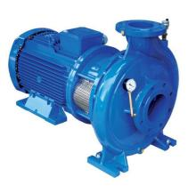
Одноступенчатые насосы моноблочного типа с закрытым рабочим колесом предназначены для перекачки чистых жидкостей с содержанием абразивных частиц размером до 0,1 мм., концентрацией до 0,2%. и температурой до 140 °C.
